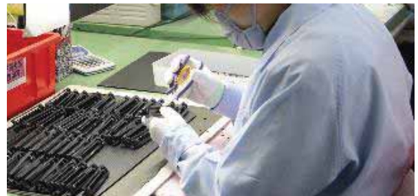
↑ ゲートカット&外観検査中の様子 「次工程に不良は流さない」を念頭に各作業者が検査を行っています。
